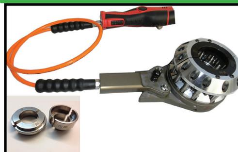
Für jede Dimension der Verbindung gibt es passende Einlagen für den Presskopf. Diese müssen der Rohrdimension passend in den Presskopf eingelegt werden.
